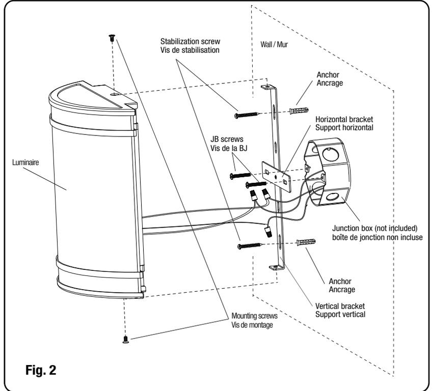
**SURFACE MOUNT FOR 28 W MODEL / MONTAGE EN SURFACE POUR LE MODÈLE 28 W**
