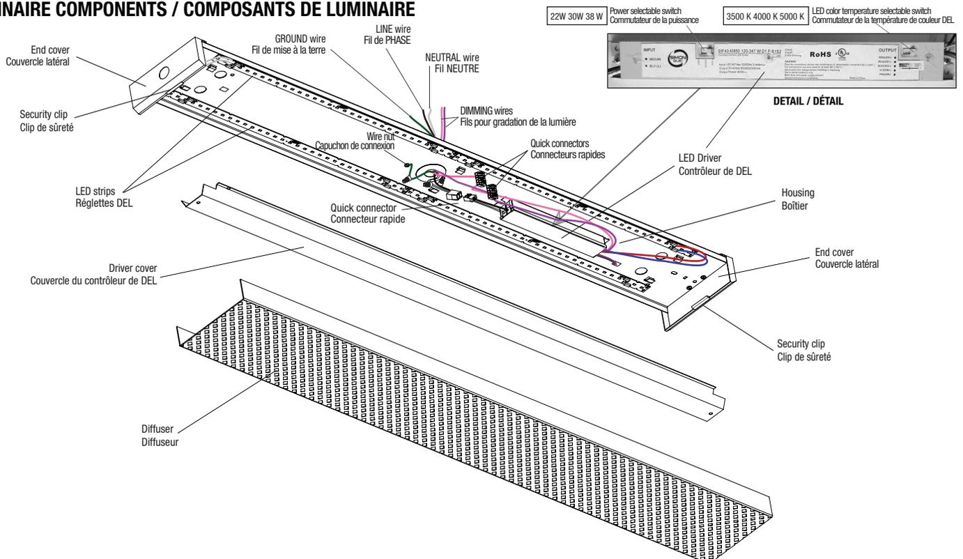
**2 DIFFUSER AND DRIVER COVER INSTALLATION/ INSTALLATION DU DIFFUSEUR ET DU COUVERCLE DU CONTRÔLEUR DE DEL**
