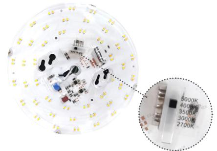
Sélectionnez facilement la température de couleur souhaitée à l'aide de l'interrupteur situé à l'intérieur du boîtier!
