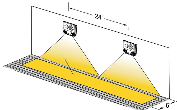
24" d'espacement sur un chemin de 6" avec un montage de 8".
