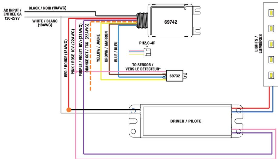
\*These wires can be capped when sensor connection is not needed / \*Ces câbles peuvent être isolés lorsque la connexion du capteur n'est pas nécessaire.
